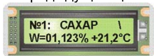
Рис. 1.1.2. Вид ЖКИ БУК в Основном режиме (режиме «Измерение») Прогреть прибор не менее 20 минут.
